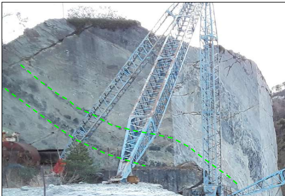
Aspetto delle oficalciti in coltivazione, in verde la scistosità principale
